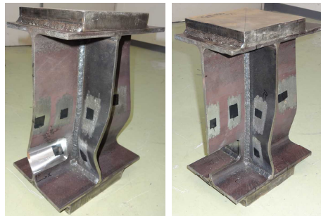
断面欠損を持つ鋼桁支点部模型の圧縮実験
