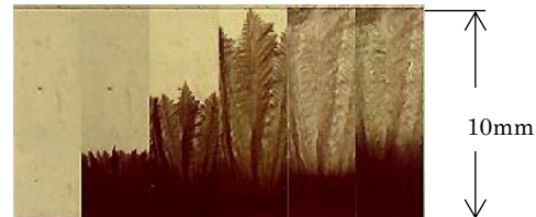
図2 凝固の様相(2%塩化ナトリウム水溶液)
