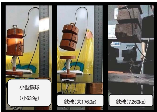
写真3 小型, 大型実験での積載物の跳び方の違い
