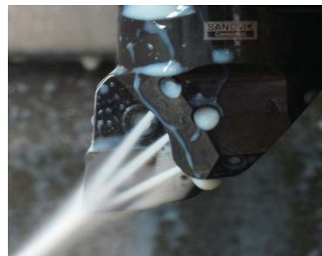
図3 高圧クーラント刃先近傍の様子
