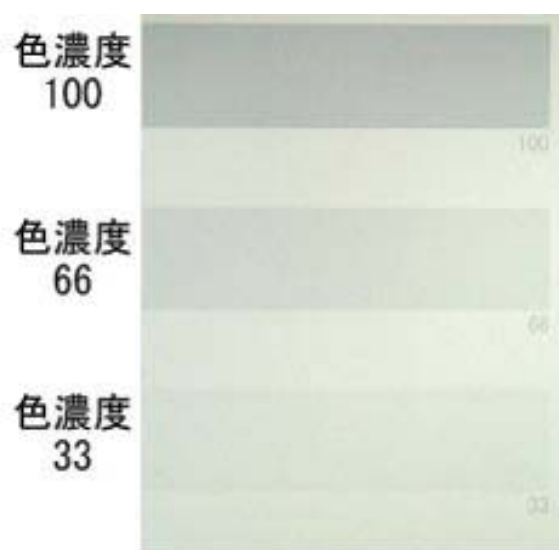
図2 インクジェット法によって PH500 とエタノール (40 wt. %) との混合溶液の塗布した試料の光学写真
