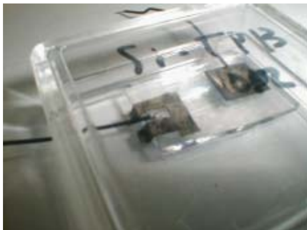
図 6 導電性粘着テープのみを用いた場合の結線
